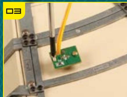
**03** Расположите плату диода так, чтобы крепежные отверстия совпали. Зафиксируйте диод с помощью двух винтов.
